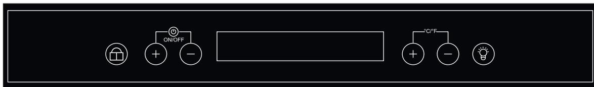
Нажмите левые **+** или **-** для регулировки температуры верхней зоны и правые **+** или **-** для регулировки температуры нижней зоны.
